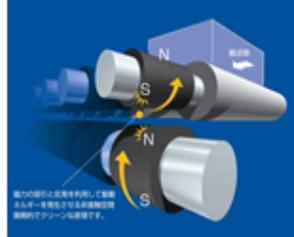
GM18Hの駆動源には非接触駆動のマグネットドライブを採用しています。世界初、磁力の吸引と反発原理を用いて搬送ローラを回転させます。これにより従来のベルト式に比べ、極めて効率的かつロスが少ない駆動を実現しました。
